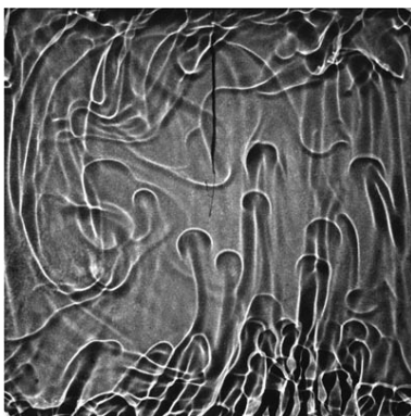
Obr. 37 — Stínová fotografie konvektivního proudění. Změny \rho a T způsobují změny indexu lomu n(\rho, T) , které se projevují ve vrženém stínu odkláněním paprsků a kaustikami. Převzato z ( http://www.math.nyu.edu/aml/wetlab/projects/3d-convection.html ).
