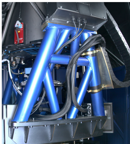
Obr. 31 — Spočtené deformace vidlice, respektive části alt–azimutální montáže, při působení síly 1 300 N na horní část, kde budou umístěny domečky pro momentové motory. Maximální posunutí činí 20\text{ }\mu\text{m} . Vpravo výsledná podoba montáže.
