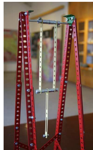
Obr. 1 — Dvojkyvadlo sestavené z Merkurů jakožto jednoduchý chaotický systém.
