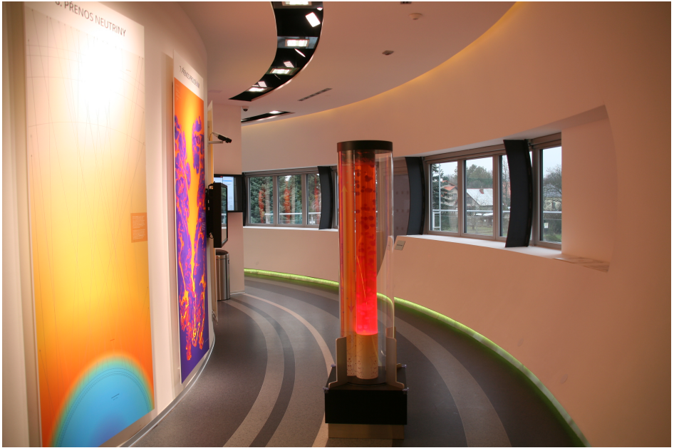
Obr. 3 — Pohled do prvního patra planetária, kde se nachází exponát demonstrující konvekci neboli přenos energie prouděním. Ve spodní části skleněného válce svítí žárovka, která zahřívá vodu a speciální vosk. Po zahřátí na provozní teplotu asi 60\text{ }^{\circ}\text{C} , což může trvat několik hodin, se změní skupenství vosku z pevného na kapalné. Bublina vosku pak má hustotu \rho_1 o málo nižší, než je hustota \rho_2 okolní vody, takže vztlaková síla F_{vz} = \rho_2 V g na ni působící je větší než gravitační F_g = \rho_1 V g ; bublina tudíž stoupá vzhůru. Nahoře u hladiny ovšem bublina odevzdá část své vnitřní energie okolí, zmenší se její teplota, vzroste hustota \rho_1 > \rho_2 , F_{vz} < F_g , opět klesne dolů a cyklus se opakuje. Spodek válce by ve Slunci odpovídal rozhraní mezi zónou zářivou a konvektivní. Vršek válce je naopak obdobou atmosféry Slunce, odkud jsou vyzařovány fotony do meziplanetárního prostoru. V pozadí je vidět též infračervená kamera (spolu s vizuální kamerou), vhodná pro diskusi přenosu energie zářením. Na severní terase je pak umístěna meteostanice.
