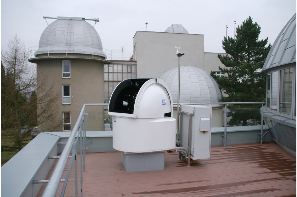
Obr. 2 — Robotický dalekohled na jižní terase umožňuje pozorování Slunce malým přístrojem Lunt LS60THa, d = 60 mm, f = 600 mm, s úzkopásmovým filtrem H_{\alpha} (656,3 nm) s propustností jen 0,07 nm, laděným pneumaticky. Je vybaven CCD kamerou Skynyx2–2, 1616 \times 1232 pixelů, s frekvencí 12 snímků za sekundu. Pro noční pozorování je určen dalekohled Televue TV60APO, d = 60 mm, f = 360 mm. Oba jsou umístěny na upravené paralaktické montáži Losmandy G–11. Profesionální interaktivní ovládání s vizualizací všech procesů umožňuje automatický nájezd na Slunce nebo na Měsíc dle spočtené efemeridy, případně na zadané nebeské souřadnice. Prakticky stejné ovládání se používá i pro vzdálené řízení dánského dalekohledu o průměru 1,54 m, umístěného na La Silla v Chile, nebo našeho největšího dvoumetrového dalekohledu Zeiss v Ondřejově. Vyrobeno hradeckou firmou Projectsoft.
