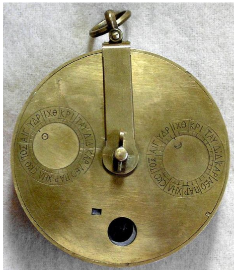
Obr. 14 — Zadní strana repliky od pana Michaela T. Wrighta [5]. Kruhová stupnice v levé části se znaky zvěrokruhu a symbolem Slunce a v pravé části stejná stupnice, ale se symbolem Měsíce, ukazují aktuální polohu těles na ekliptice. V kruhovém otvoru ve spodní části je vidět aktuální fázi Měsíce a v přilehlém okénku vlevo se zobrazuje stáří Měsíce. Obrázek přední strany je dostupný v [1].
