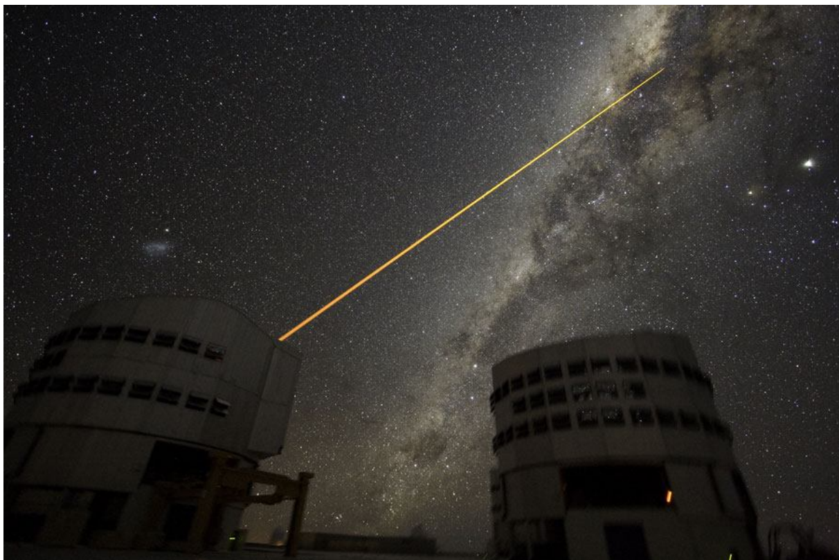
Obr. 48: Laser vytváří umělou hvězdu pro adaptivní optiku jednoho z dalekohledů VLT.
