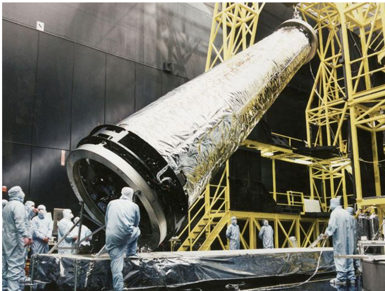
Obr. 55: Wolterovo zrcadlo družice Chandra.
