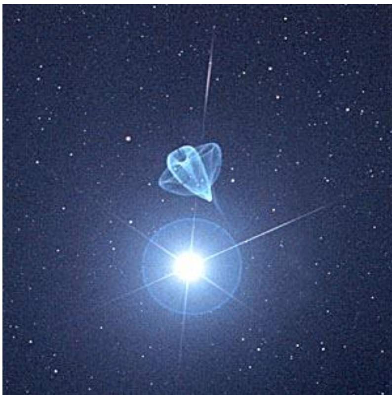
Obr. 42: Vnitřní odrazy uvnitř Schmidtovy kamery kolem jasných objektů, zde Venuše. Paprsky vznikají ohybem světla na držácích nesoucích detektor.
