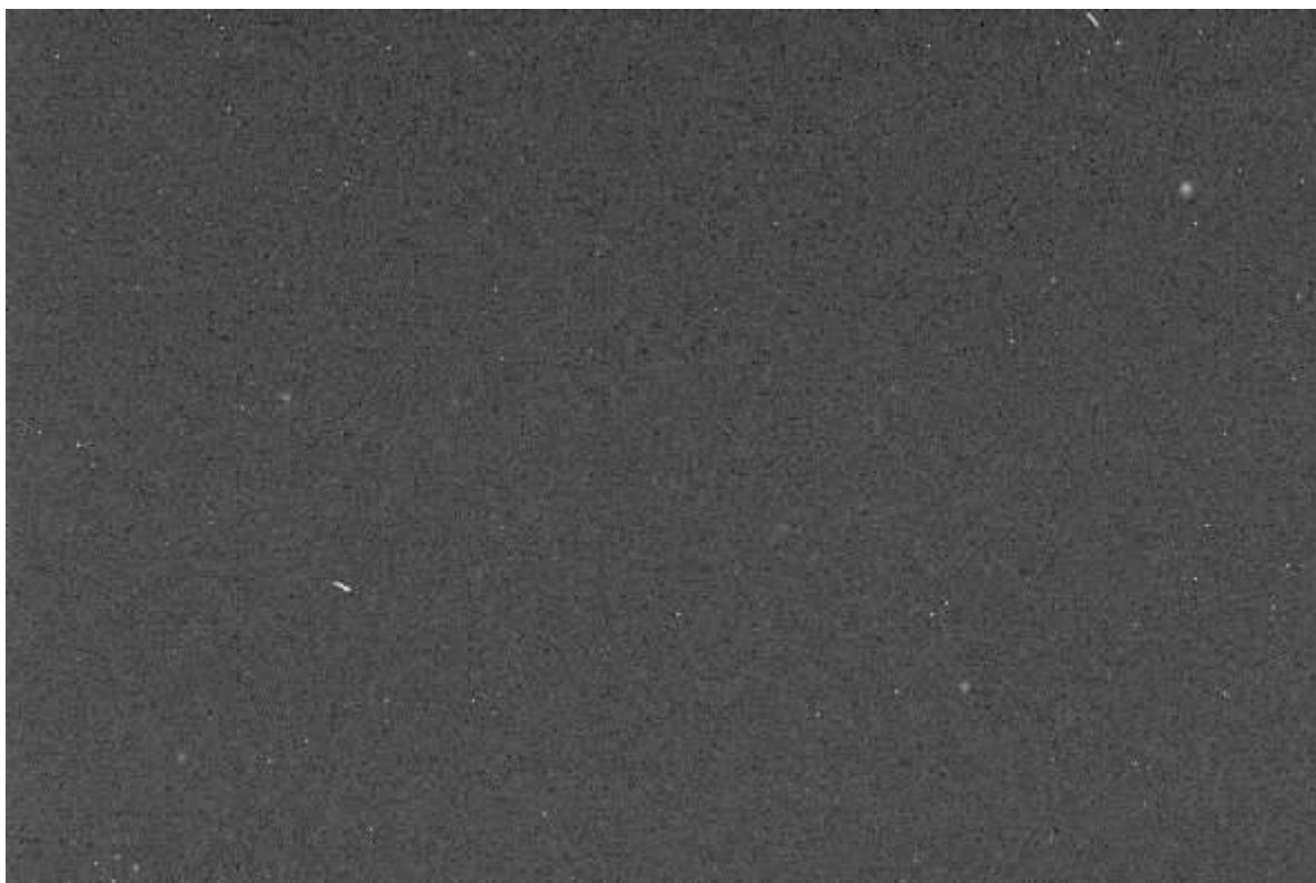
Obr. 26: Dark frame. Bílé tečky jsou hotpixely a zásahy CCD čipu kosmickým zářením.
