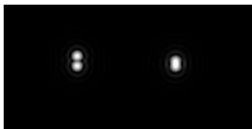
Obrázek 2.16: Rozlišovací schopnost dalekohledu (vlevo: Rayleighovo kritérium, vpravo: Dawesovo kritérium). Převzato z http://posec.astro.cz/ .
