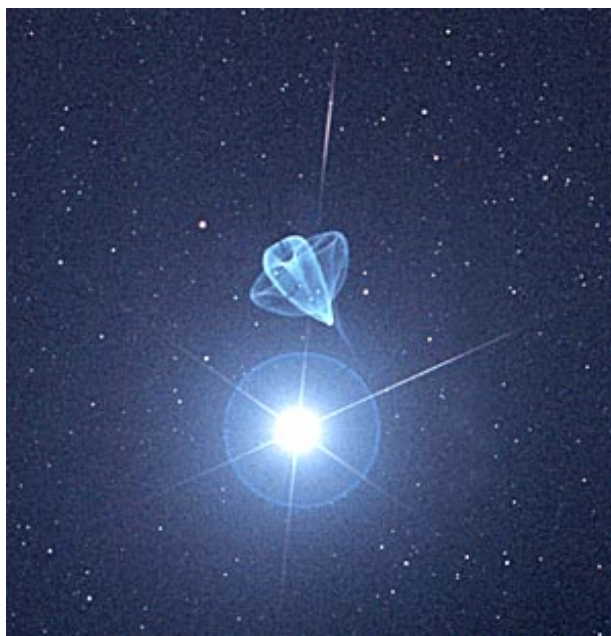
Obrázek 2.23: Vnitřní odrazy uvnitř Schmidtovy kamery kolem jasných objektů, zde Venuše. Paprsky vznikají ohybem světla na držácích nesoucích detektor. Převzato z http://www.robertreeves.com/repair1.htm .
